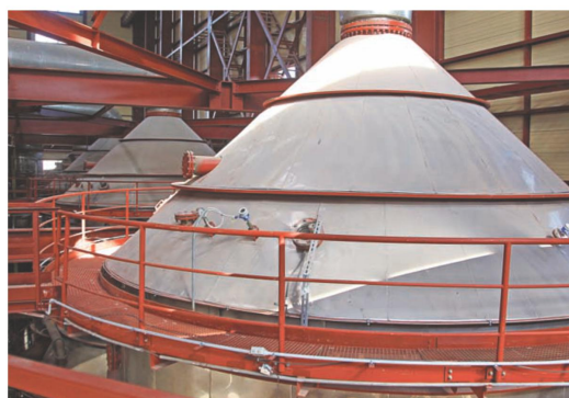
Корпуса вакуум-кристаллизаторов на отметке 20,15 м.
